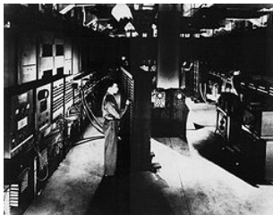
Computador ENIAC (programadores utilizando a máquina e detalhe das válvulas na parte de trás)
