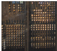
Computador ENIAC (programadores utilizando a máquina e detalhe das válvulas na parte de trás)
