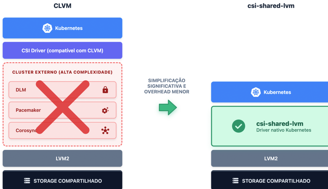
Figura 2: Comparativo da pilha de software. À esquerda, a complexidade da abordagem tradicional baseada em CLVM. À direita, a abordagem simplificada proposta neste trabalho, eliminando a dependência de gerenciadores de cluster externos.
