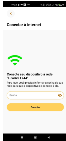
Figura 14: Fluxo onde é pedida a senha do Wi-Fi para conectar a placa à internet
