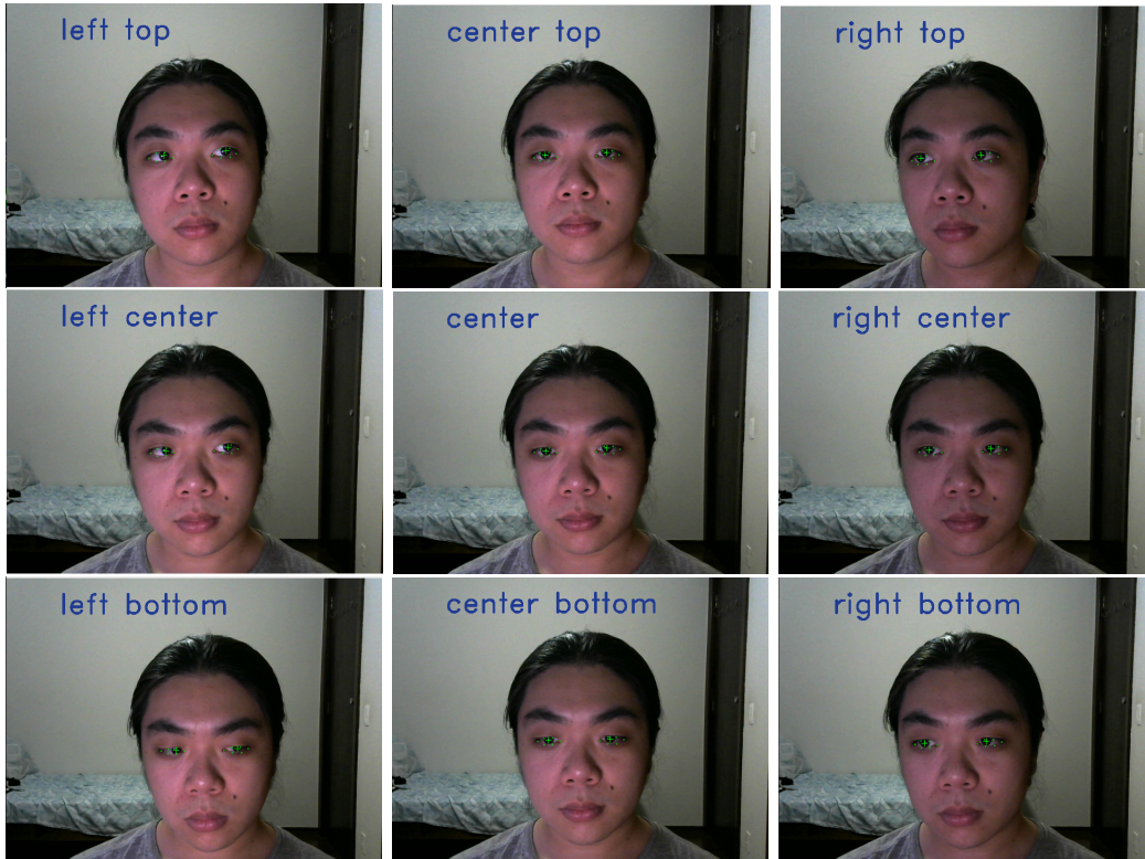
Figura 4: Detecção da direção do olhar pelo protótipo.
