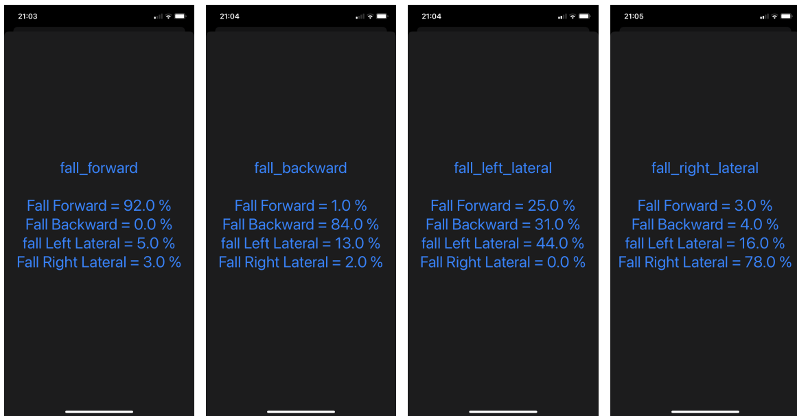
(a) Queda para frente com 92% de precisão. (b) Queda para trás com 84% de precisão. (c) Queda na lateral esquerda com 44% de precisão. (d) Queda na lateral direita com 78% de precisão.
