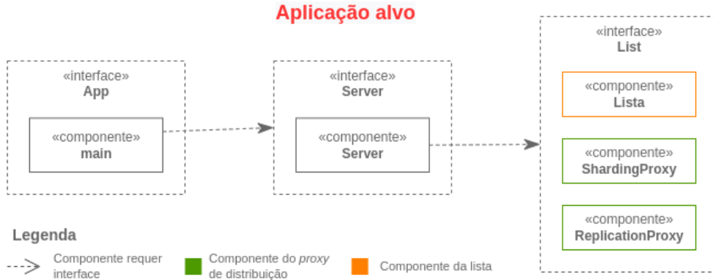
Figura 7: Os componentes da aplicação e suas interfaces. Dentro das interfaces App , Server e List , demarcadas com linhas pontilhadas, temos os componentes que as implementam, respectivamente: main , Server , List e os proxies de distribuição ShardingProxy e ReplicationProxy .
