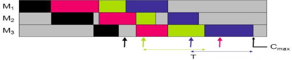
Figura 1: Exemplificação do problema do *flowshop*, onde as setas coloridas indicam os prazos de suas respectivas tarefas, neste caso da imagem temos duas tarefas atrasadas, concluídas em um tempo posterior ao indicado pela seta. Com o tempo de completude total indicado por  $C_{max}$ .
