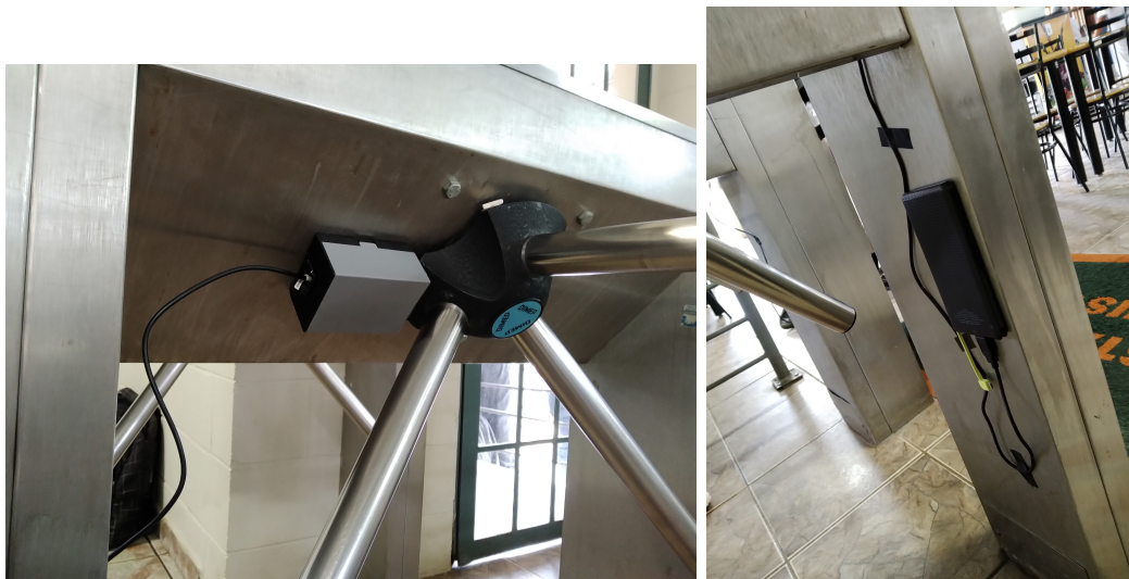
Figura 7: Sensor instalado na catraca
