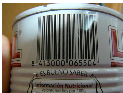
Figura 4: Partes do código EAN-13: o dígito de checagem é 8; o grupo esquerdo é composto pelos dígitos 413000; o grupo direito é composto pelos dígitos 065504; os padrões de início, do meio e do fim podem ser percebidos pelas barras verticais maiores.
