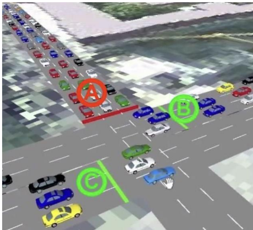
Figura 6: Exemplo de cruzamento com 3 fluxos, mas apenas 2 tempos, devido aos fluxos B e C não se cruzarem.
