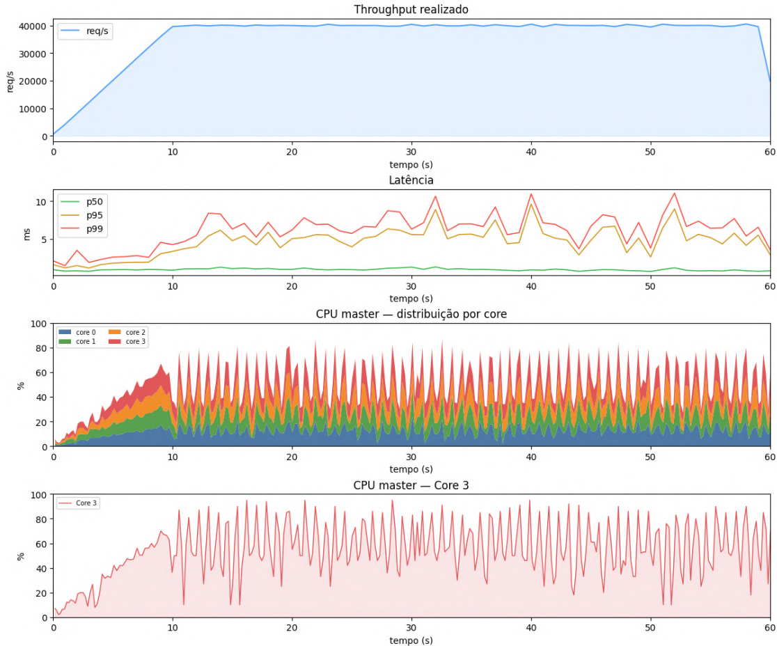
Figura 3: vazão, latência e uso de CPU do master durante o teste a 40 mil req/s
