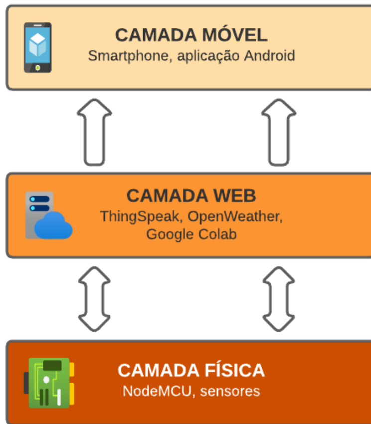
Figura 2: Arquitetura proposta para o projeto de monitoramento de erosão de solo.
