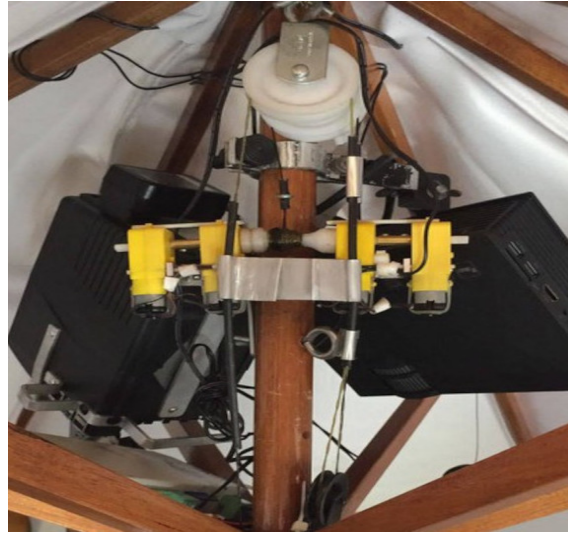
Figura 7: Conjunto de 4 motores com redução acoplados em linha com o carretel que traciona o fio, conduzido entre as 4 polias para abertura e fechamento do chapéu.
