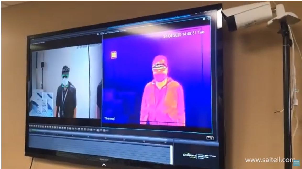
Figura 15: Câmera térmica, painel PC e sistema de monitoramento [16].
