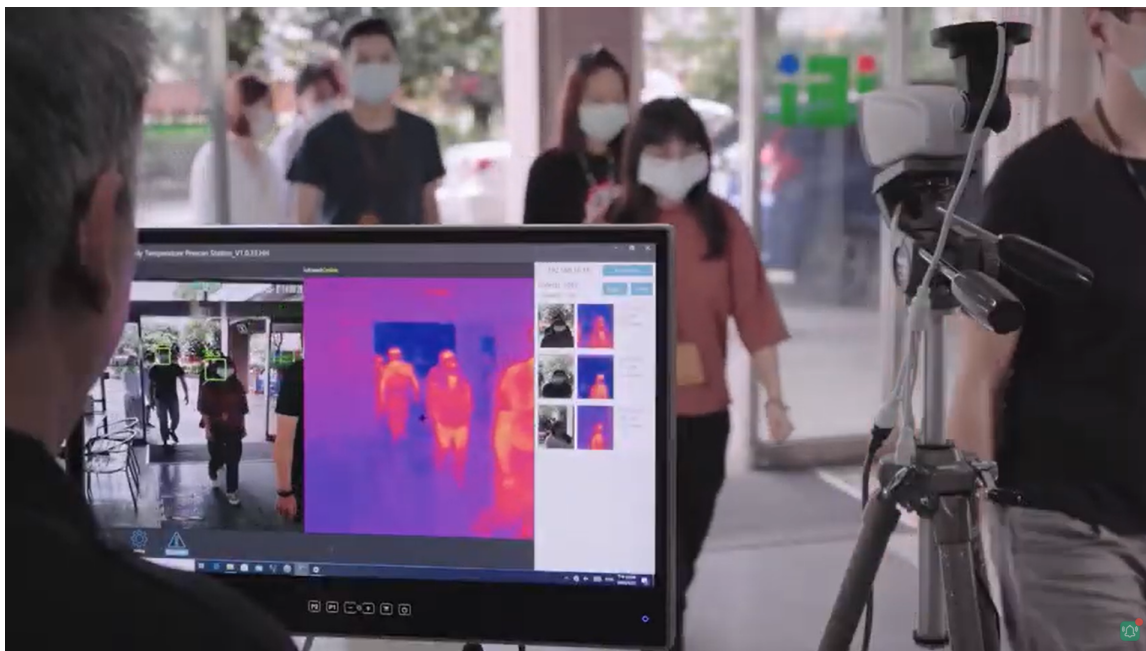
Figura 13: Sistema integrado câmera e panel PC através de cabo de rede.[15].
