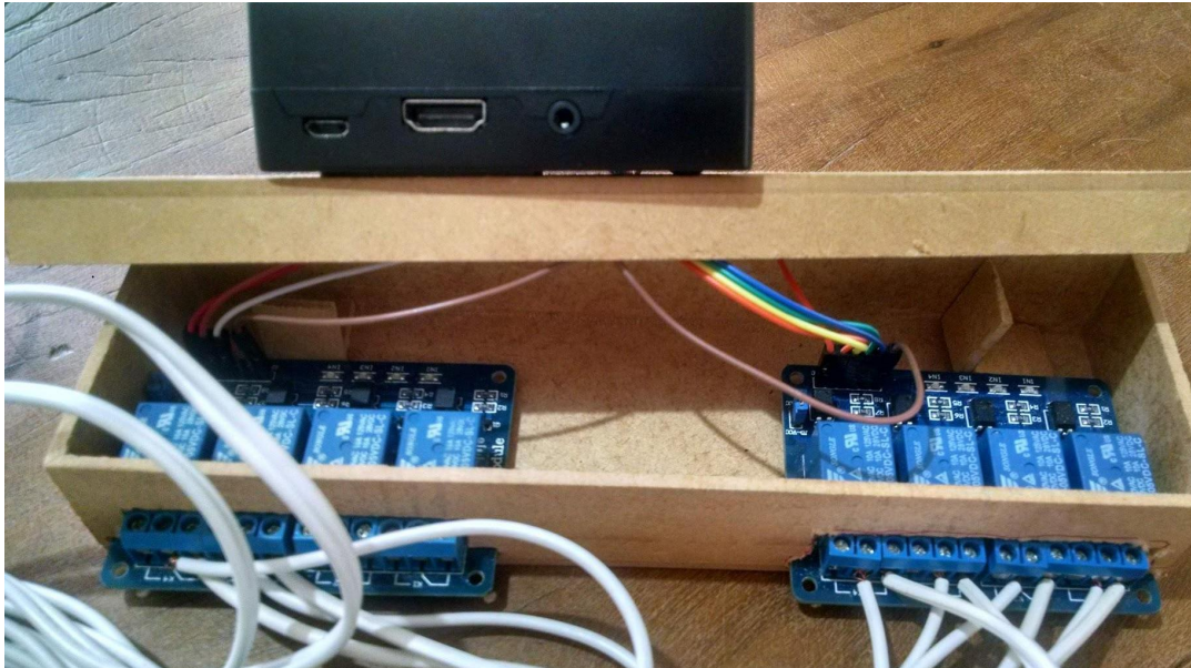
Figura 4 - Módulo controle de luz
