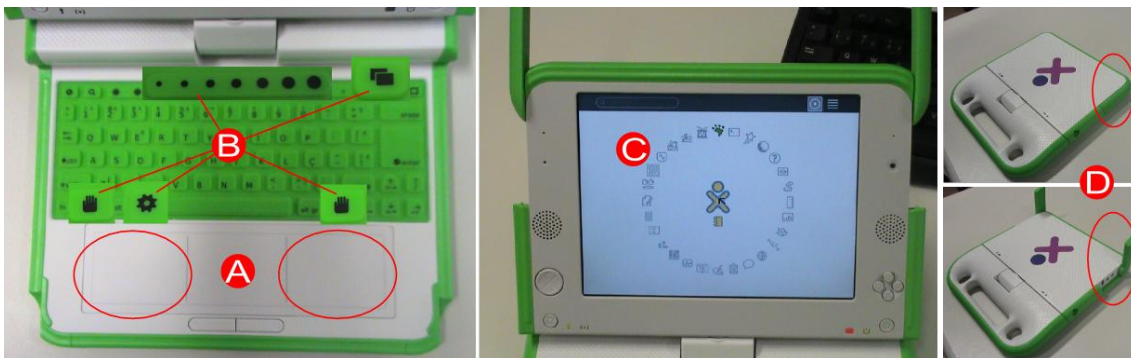
Figura 2. Alguns dos problemas encontrados na atividade de avaliação. Itens: a) áreas não funcionais do touchpad , b) teclas aparentemente sem função, c) aplicativos dispostos sem agrupamentos e d) mecanismo de abertura.
