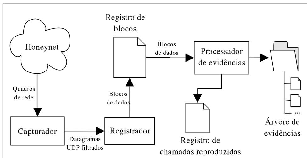
Figura 4. Módulo receptor.
