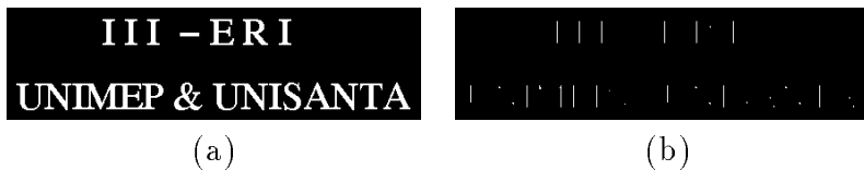
Figura 21: Imagem original (a), e imagem erodida (b).
