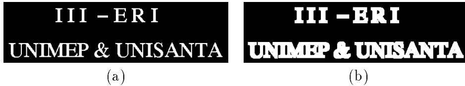
Figura 20: Imagem original (a), e imagem dilatada (b).
