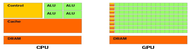
Figure 5: Diferença arquitetural entre CPU e GPU [1].
