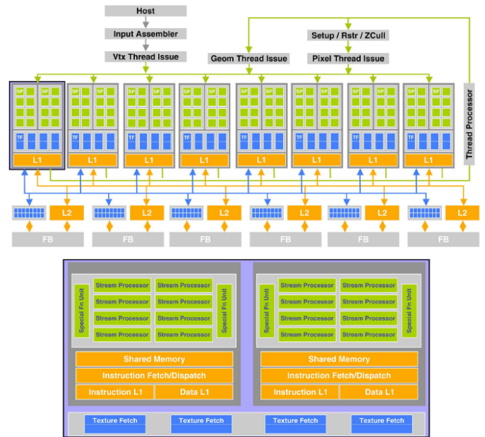
Figure 2: Arquitetura da GPU NVIDIA GeForce 8800 GTX. Extraído de Owens et al. [10]
