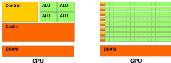
Figura : Diferença arquiteturais entre CPU e GPU. NVIDIA (2008)
