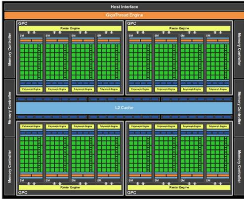
Figura 2: GPU da arquitetura Fermi. Extraído de [7].
