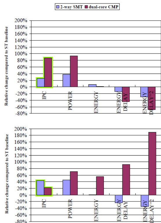
Figura 2. Comparação de performance e eficiência de energia entre SMT e CMP para workload com baixo (gráfico de cima) e alto (gráfico de abaixo) taxa de miss na L2.
