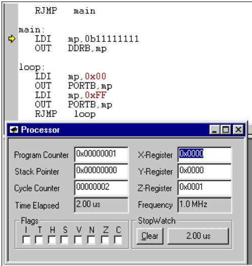
Após o primeiro passo ser executado, a janela do processador ficaria como ao lado.
