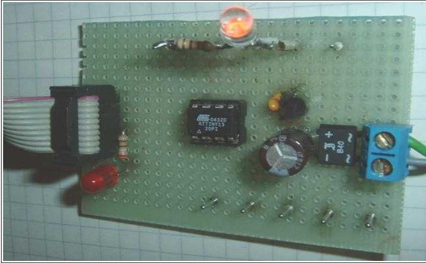
O ATtiny13 não requer cristal externo ou gerador de clock, pois trabalha com o seu gerador RC interno de 9,6 Mcs/s e, por padrão, com um divisor de clock em 8 (frequência de clock de 1,2 Mcs/s).
