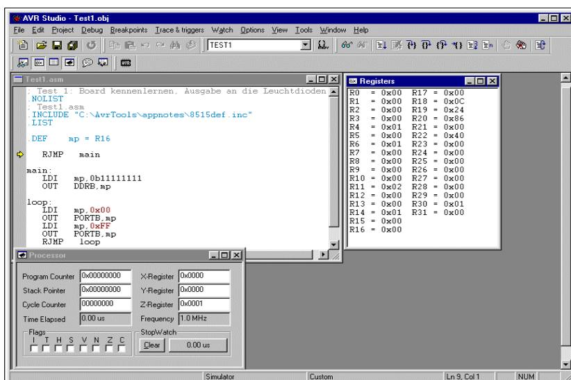
A janela do processador mostra vários valores, como onde o contador de comando está, os registradores de flag de status, e a informação sobre temporização (aqui a um clock de 1 MHz). O cronômetro por ser usado para fazer uma medida exata do tempo necessário para executar rotinas etc.
