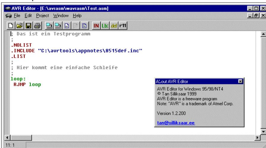
O editor reconhece os comandos automaticamente e usa diferentes cores (destaque da sintaxe) para sinalizar ao usuário constantes e erros de digitação nestes comandos (em preto). O código armazenado no arquivo .asm é basicamente o mesmo, pois as cores não são armazenadas no arquivo.
