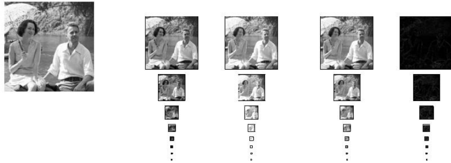
Figure 40: Uma imagem original (esquerda), pirâmide produzida por redução intervalar (centro) e pirâmide produzida por redução de média e desvio (direita).
