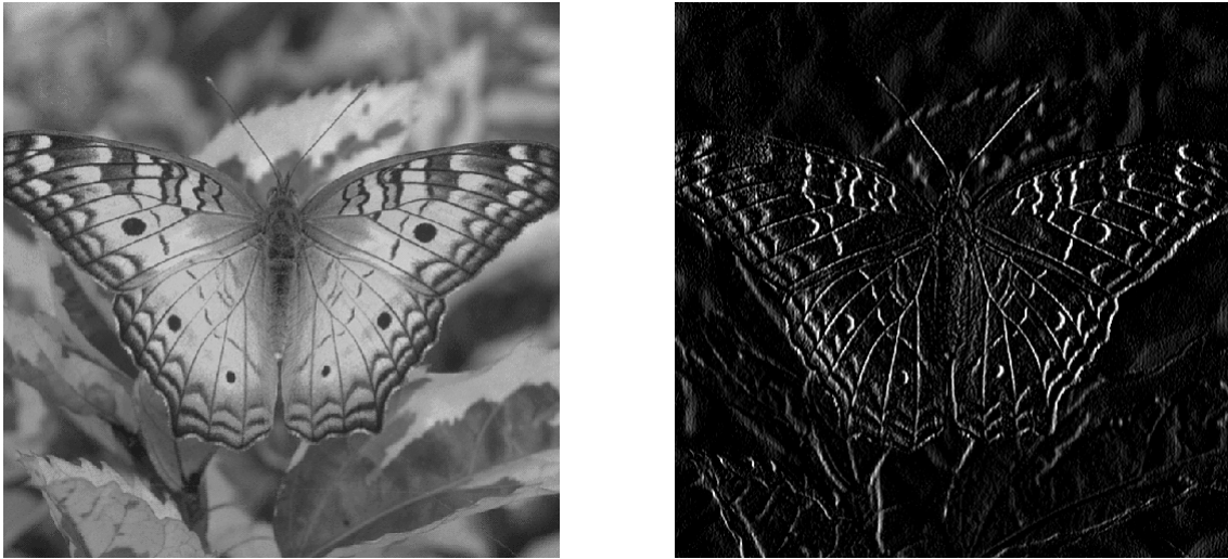
Figura 1.6.3 - Imagens butterfly.png (esquerda) e butterfly_h3_convolution.png (direita).
