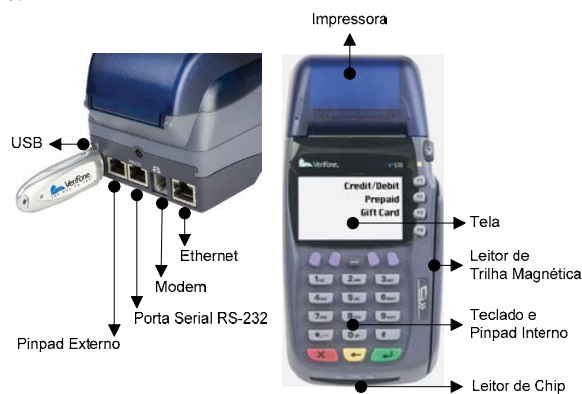
Figura 4. Terminal POS e seus principais componentes periféricos 3
