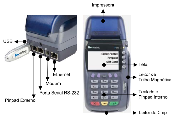
Figura 4. Terminal POS e seus principais componentes periféricos 3
