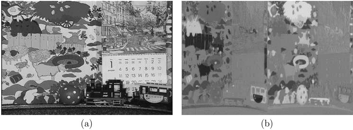
Figura 20: Quadro de vídeo no formato YCbCr:422. (a) Componente Y (b) Componentes Cb e Cr.
